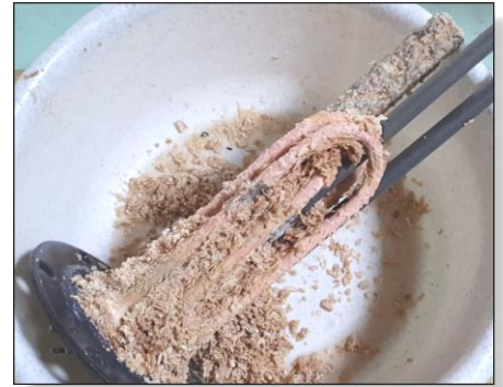
1. kép: Megkímélt bojler vízkővel belepített fűtőszála és anódja takarítás után 3 évvel (fotó: Cz. Sz.)
